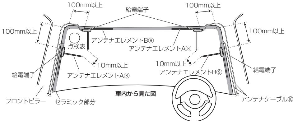
アンテナエレメントの給電端子がフロントガラス周縁のセラミック部分またはフロントピラーの端から25mm以内の位置になるように貼り付けてください。
