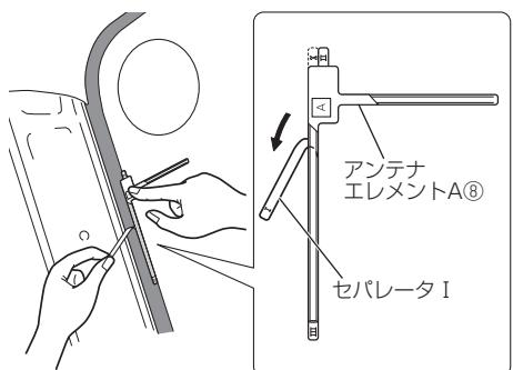
6. アンテナエレメントを押さえながらセパレータIIをはがし、アンテナエレメントを貼り付けます。
