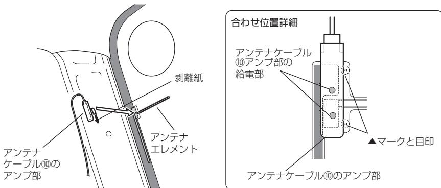
9. アンテナケーブル⑩を配線します。必要に応じてケーブルをソフトテープ⑫で固定して配線します。
