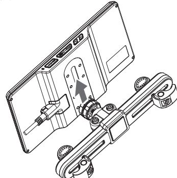
2 取付アーム①のナット部を締めて、適当な高さでモニターを仮止めする。
