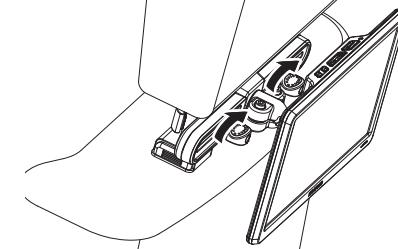
△注意 シャフトに確実に固定してください。締め付けが足りないと取付アーム①が脱落する原因となります。
