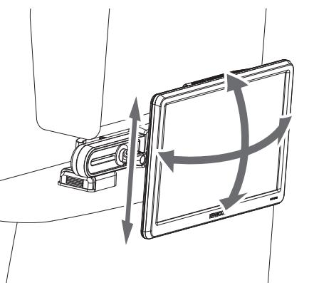
7 取付アーム①のナットと六角ネジを締め付けてモニターの角度と高さを固定する。
