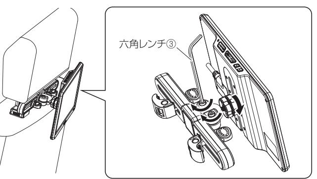
△注意 ナットおよび六角ネジをしっかりと締め付けモニターを確実に固定してください。ヘッドレストに取り付けた状態で取付アーム①のナットおよび六角ネジを締め付けできない場合は、一旦ヘッドレストから取付アーム①を外してから締め付けてください。
