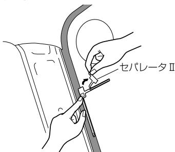
5. アンテナエレメントを押さえながらセパレータⅠをはがし貼り付けます。
