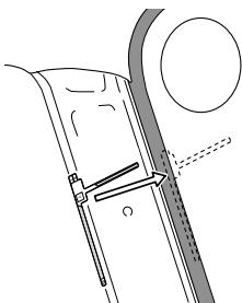
6. アンテナエレメントを押さえながらセパレータⅡをはがし、アンテナエレメントを貼り付けます。
