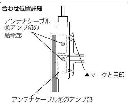
9. アンテナケーブル⑩を配線します。必要に応じてケーブルをソフトテープ⑫で固定して配線します。
