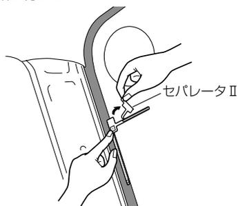
7. 樹脂製のヘラなどでフィルムの上からアンテナエレメント⑨を十分に密着させた後、保護フィルムIIIを静かにはがします。
