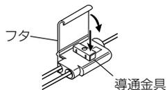
**注意** 中継コネクタ⑦は「電源の接続」の指定のコードとETC/ステリモケーブル⑬を接続するとき以外は使用しないでください。接触不良による誤動作の原因となります。
