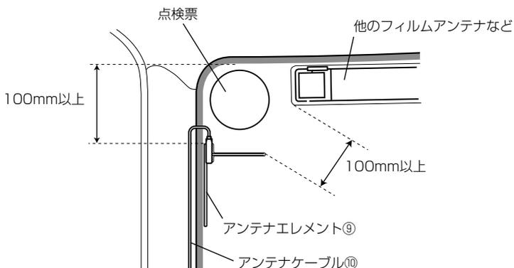
アンテナエレメント⑨の給電端子がフロントガラス周縁のセラミック部分またはフロントピラーの端から25mm以内の位置になるように貼り付けてください。
