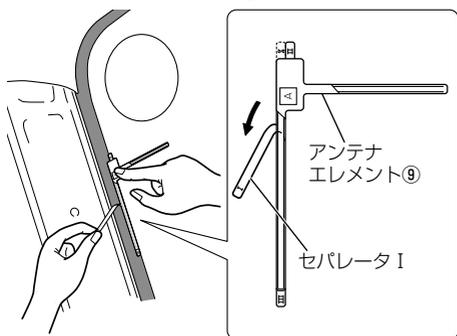
6. アンテナエレメント⑨を押さえながらセパレータIIをはがし、アンテナエレメント⑨を貼り付けます。
