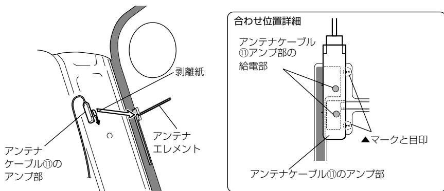
9. アンテナケーブル⑪を配線します。必要に応じてケーブルをソフトテープ⑬で固定して配線します。
