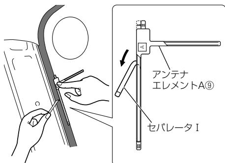
**7.** 樹脂製のヘラなどでフィルムの上からアンテナエレメントを十分に密着させた後、保護フィルムⅢを静かにはがします。
