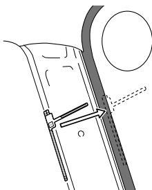
**6.** アンテナエレメントを押さえながらセパレータⅡをはがし、アンテナエレメントを貼り付けます。
