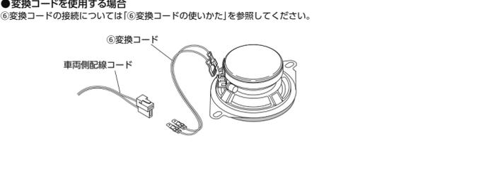
● ⑥ 変換コードの使いかた 車両側コネクタが、右図のような「T型タイプ」の場合に使用します。
