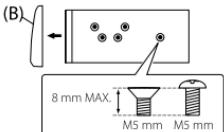
**⚠** Χρησιμοποιήστε μόνο τις προβλεπόμενες βίδες. Εάν χρησιμοποιήσετε λάθος βίδες μπορεί να προκληθεί βλάβη στη μονάδα.
