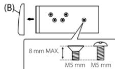
⚠ Använd endast specificerade skruvar. Användning av fel slags skruvar kan skada bilstereon.
