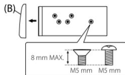
⚠ Χρησιμοποιήστε μόνο τις προβλεπόμενες βίδες. Εάν χρησιμοποιήσετε λάθος βίδες μπορεί να προκληθεί βλάβη στη μονάδα.
