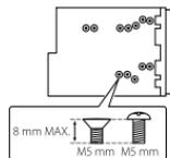
⚠ Използвайте само определените болтове. Използването на неподходящи болтове може да повреди устройството.
