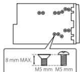
⚠ Brug kun de specificerede skruer. Brug af forkerte skruer kan beskadige enheden.
