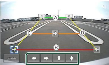
Stellen Sie sicher, dass **A** und **B** horizontal parallel zueinander stehen und dass **C** und **D** gleich lang sind.
