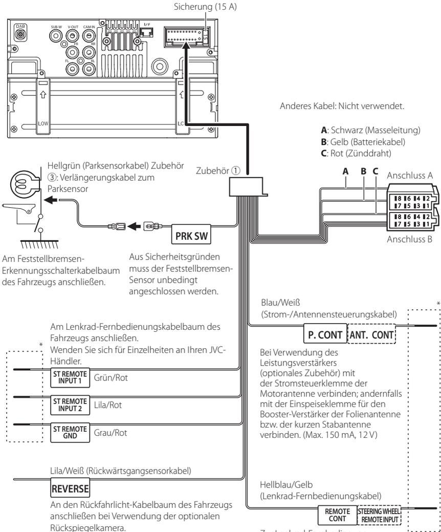
\* Ziehen Sie das Kabel nicht aus dem Schrumpfschlauch, bis Sie den Anschluss vornehmen.
