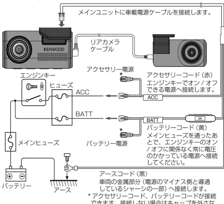
\* アクセサリーコード、バッテリーコードが接続できます。接続しない場合はキャップを外さないでください。
