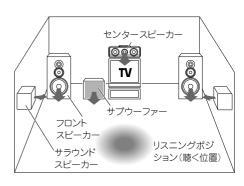
**フロントスピーカー**:前面左右に設置します。モードにかかわらず
