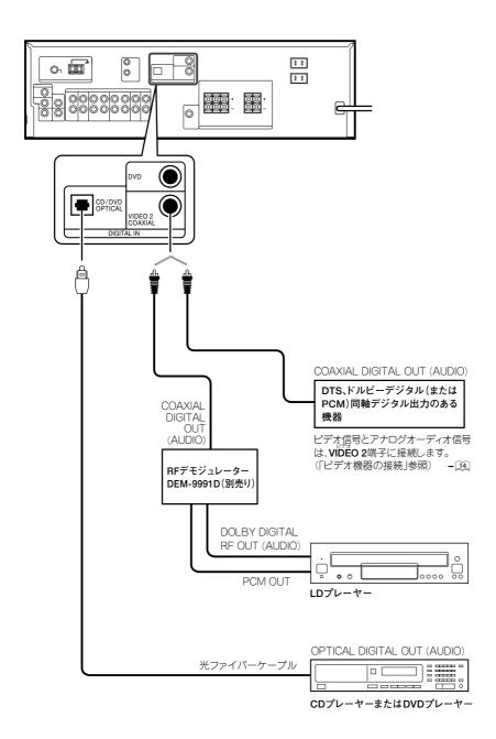
アジタル DIGITAL RF OUT端子のあるLDプレーヤーを接続するには、LDプレーヤーを別売りのRFデモジュレーター (DEM-9991D) に接続します。
