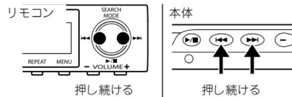
▶▶| : 押し続けると曲番号が進む方向に高速で変わります。リモコン表示部に曲番号と“JET▶▶▶”が表示されます。指を離すと曲が再生されます。
