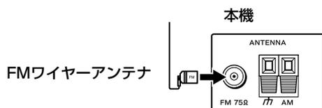
FMの受信状態が良くないときは以下のように、市販の75Ω同軸ケーブルを使って、本機と屋外アンテナをつなぎます。
