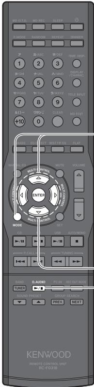
1 [D.AUDIO]キーを押して音源を切り換える
