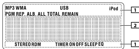
**[1]**再生しているオーディオファイルの種類や接続機器の表示、音質調整などが設定されると点灯します。
