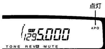
受信状態のまま 2 時間 59 分間（ベル ON 時は 23 時間 59 分間）キーが操作されない場合、【APO】表示が点滅し、ピープ音が鳴ります。
