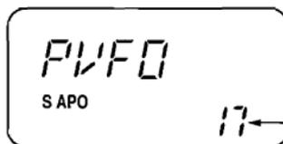
3. (MENU) を押して、周波数表示の左側3桁を点滅させる
