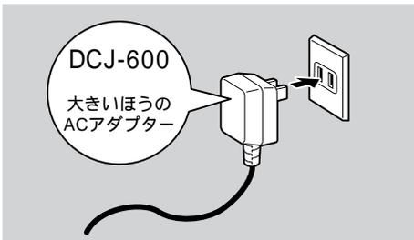
ACアダプターのプラグをDC IN端子に差し込み、コードを固定用フックに引っ掛けます。
