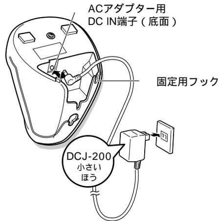
2 A C アダプターを電源コンセントに差し込む
