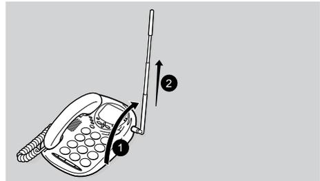
アンテナを縮めて使用すると、親機と子機間の通話距離が短くなります。親機と子機間の通話距離は、アンテナが伸びた状態で約100mです。
