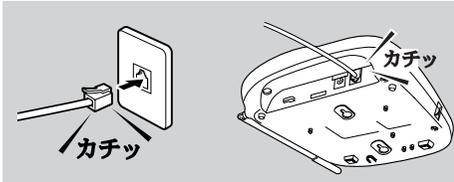
もう一端を、親機の回線 (LINE) 端子に「カチッ」と音がするまで差し込みます。電話機コードをかるく引っぱって、回線がしっかり接続されていることを確認してください。
