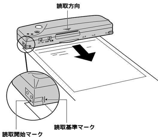
1. 読み取り基準マークを原稿の左端に合わせ、読み取り開始マークを原稿の先端に合わせる
