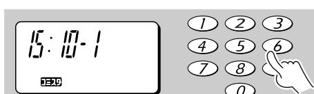
転送時刻を間違えたら
