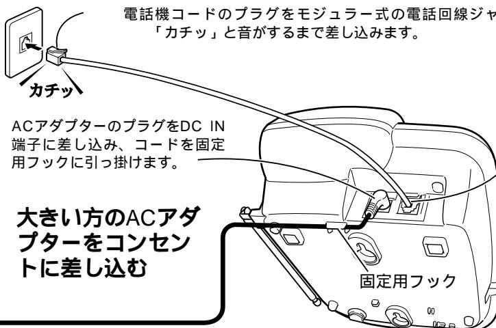
ACアダプターのプラグをDC IN端子に差し込み、コードを固定用フックに引っ掛けます。
