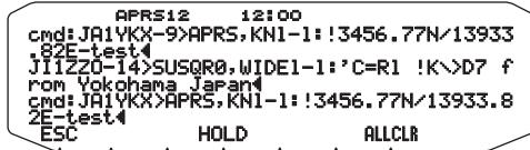
【ESC】：パケットモニターモードを抜けて、周波数表示モードに戻ります。
