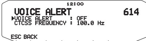
他局と音声通信をしようとする際、その局が近くにいるかどうかを聴感的に知る機能です。移動局がボイスアラート ON で移動しているとき、同様にボイスアラート ON で運用している局はトーン (CTCSS) 一致によりこの移動局のビーコン音を聞くことができる所以、相手局が近くにいて、直接交信できることがわかります。
