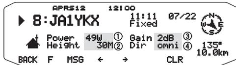
①送信パワー ②アンテナ高 ③アンテナゲイン
