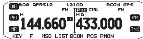
この状態で [PTT] を押して音声の交信を終えたあと [PTT] を離すと送信終了前に自局位置情報パケットが送信されます。ただし、[PTT] 操作で毎回送信するのではなく、自局位置情報パケットを送信してから自動送信間隔時間経過後に [PTT] が押されたときに送信されます。位置情報パケットの送信が可能になると、“BCON”が点滅します。
