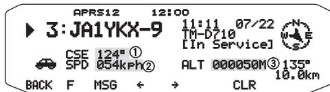
①進行方向 ②移動速度 ③高度
