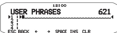
APRS のメッセージ作成モードで、あらかじめ設定しておいたフレーズをペーストできる機能（クリップボードのイメージ）です。フレーズは、最大 32 文字を 4 種類設定することができます。
