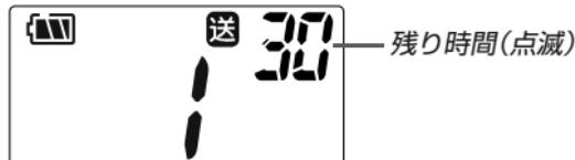
本機の1回の通信時間は、送信・受信を合わせて3分間です。通信終了の30秒前になると、表示部の数字が点滅しながらカウントダウンを始めます。10秒前になると「ピッ」と予告音が鳴り、3分を経過すると送信禁止音(ブー)とともに送信を停止し、待ち受け状態に戻ります。続けて通信するときは、送信停止2秒後に【PTT】を押して相手を呼び出してください。
