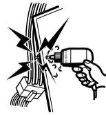
車体に穴を開けて取り付ける際は、パイプ類・タンク・電気配線などの位置を確認のうえ、これらと当たったり接触することがないようにしてください。火災の原因になります。
