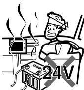
大型トラックや寒冷地仕様のディーゼル車などの24V車で使用しないでください。火災などの原因となります。本製品はDC12V $\ominus$ アース車専用です。
