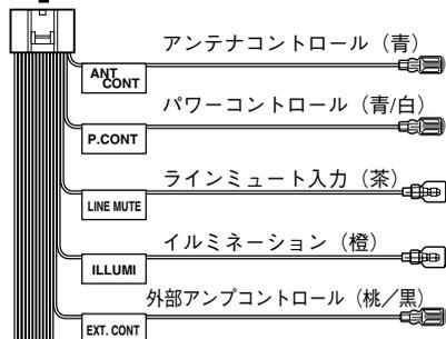
オートアンテナのコントロール端子やガラスプリントアンテナのブースターアンプの電源端子へ接続してください。接続しない場合はキャップを外さないでください。
