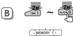
ボタンナンバ表示が1回点滅するまで押し続けます。
