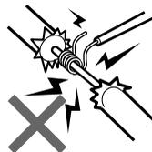
コードの被覆を切って、他の機器の電源を取るとは絶対にお止めください。リード線の電流容量をオーバーし、火災・感電の原因となります。
