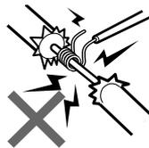
コードの被覆を切って、他の機器の電源を取ることは絶対にお止めください。リード線の電流容量をオーバーし、火災・感電の原因となります。
