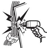
車体に穴を開けて取り付けの際は、パイプ類・タンク・電気配線などの位置を確認のうえ、これらと当たったり接触することがないようにしてください。火災の原因になります。
