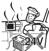
大型トラックや寒冷地仕様のディーゼル車などの24V車で使用しないでください。火災などの原因となります。本製品はDC12V⊖アース車専用です。
