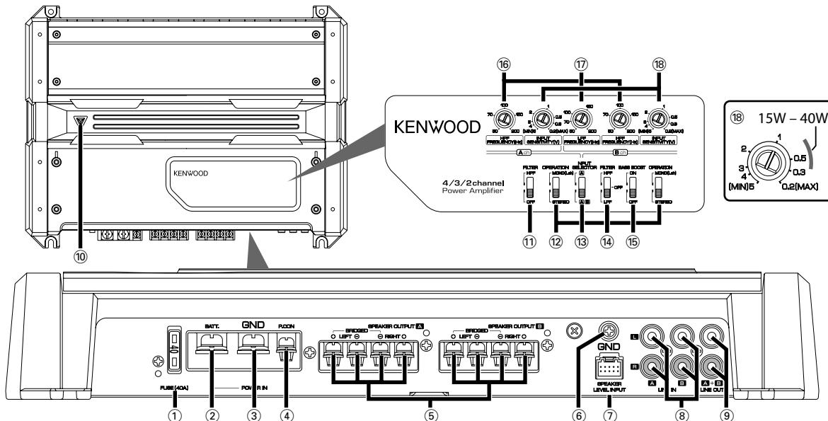
● 端子側カバーの下に調整パネルがあります。調整するときは、カバーを取り外してください。(5ページをご覧ください)
