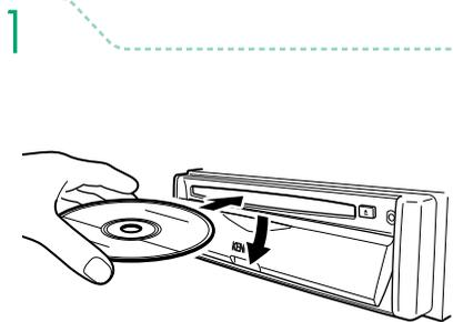
1 正面パネルを開き、レーベル面（文字や絵が印刷された面）を上にしてディスクを挿入します
