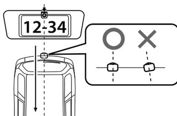
カメラはナンバーを隠さないように中央部分に貼り付けます。また車の進行方向に対してまっすぐ取り付けてください。カメラを車のセンター方向(中央側)に傾けないでください。
