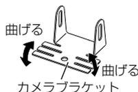
カメラを取り付ける場所に合わせてカメラブラケットを整形してください。
