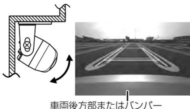
カメラ角度調整のとき、カメラコードが突っ張らないように注意してください。
