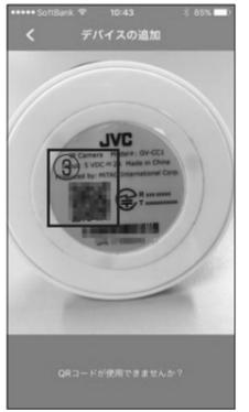
IP カメラスタンドの裏にある③ QR コードを読み込みます。以降の操作は、IP カメラ設定編を参照願います。
