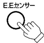
押すたびに、E.E.センサーの「入/切」が切り換わります。E.E.センサーを「入」にすると、本体のE.E.センサーランプが緑色に点灯します。
