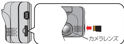
メモリーカードを取り出すときは、メモリーカードを押してメモリーカードが少し飛び出したら引き抜きます。
