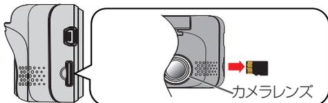
メモリーカードを押し少し飛び出したら引き抜きます。
