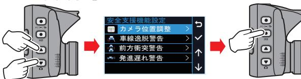
以下の手順でカメラ位置およびボンネット位置を調整する
