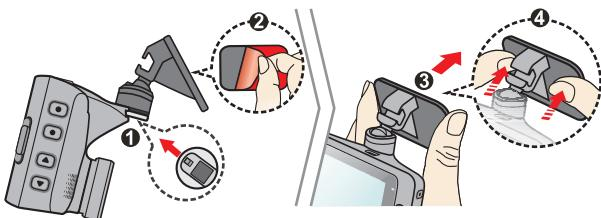
貼り付け位置を確認して貼り付けます。粘着テープの取付強度を強くするため、取付後24時間以上放置してから使用してください。
