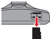
メモリーカードを押し少し飛び出したら引き抜きます。
