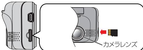
メモリーカードを取り出すときは、メモリーカードを押してメモリーカードが少し飛び出たら引き抜きます。
