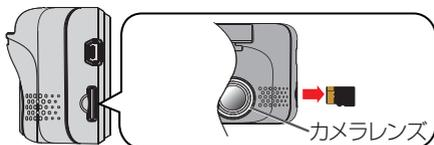
メモリーカードを押して少し飛び出したら引き抜きます。
