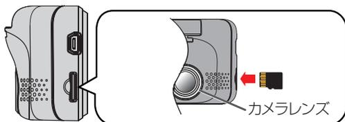
メモリーカードを取り出すときは、メモリーカードを押ししてメモリーカードが少し飛び出たら引き抜きます。
