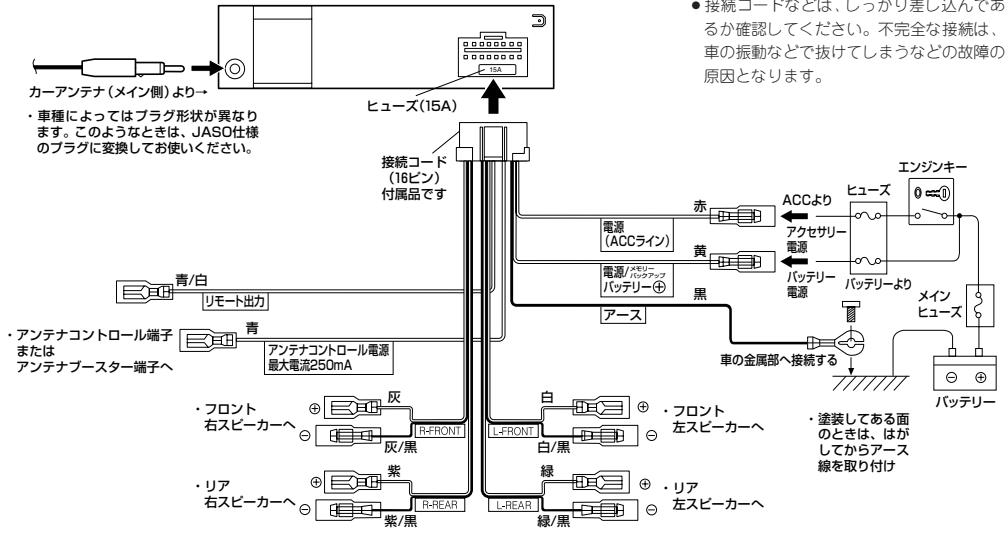
●接続コードなどは、しっかり差し込んであるか確認してください。不完全な接続は、車の振動などで抜けてしまうなどの故障の原因となります。
