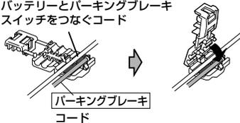
• コネクターの金属部分が、両方のコードに接触するようにしてください。
