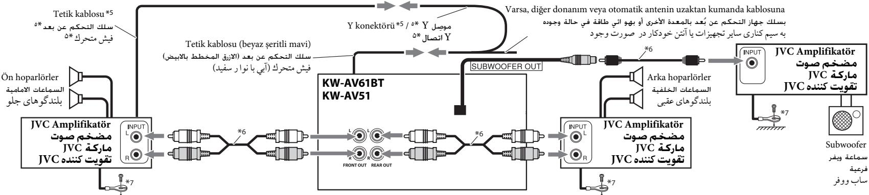
**B** اتصال وسليه هاي خارجي / توصيل اجهزة الكمبيوتر ذات الخارجية الاخرى / Harici parçaların bağlanması
