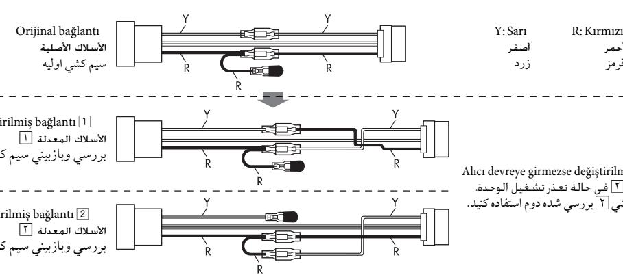
ISO konektörü kullanılmadan bağlantı / ISO التوصيل دون استخدام موصلات / ISO استفاده از رابط بدون توصیل
