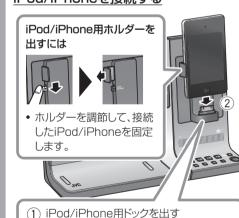
ドックの右側を押して逆方向に回転させます。
