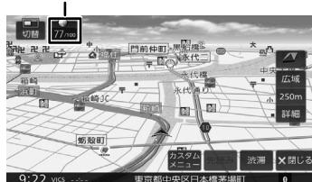
ECO ドライブ評点は、少し前からの運転状況をもとに総合評価し、100 点満点で表示されます。
