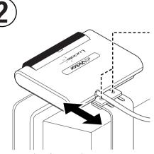
ネジをゆるめて前後に 調節します。 調節が終わったら、再 びネジを締めて固定し ます。
