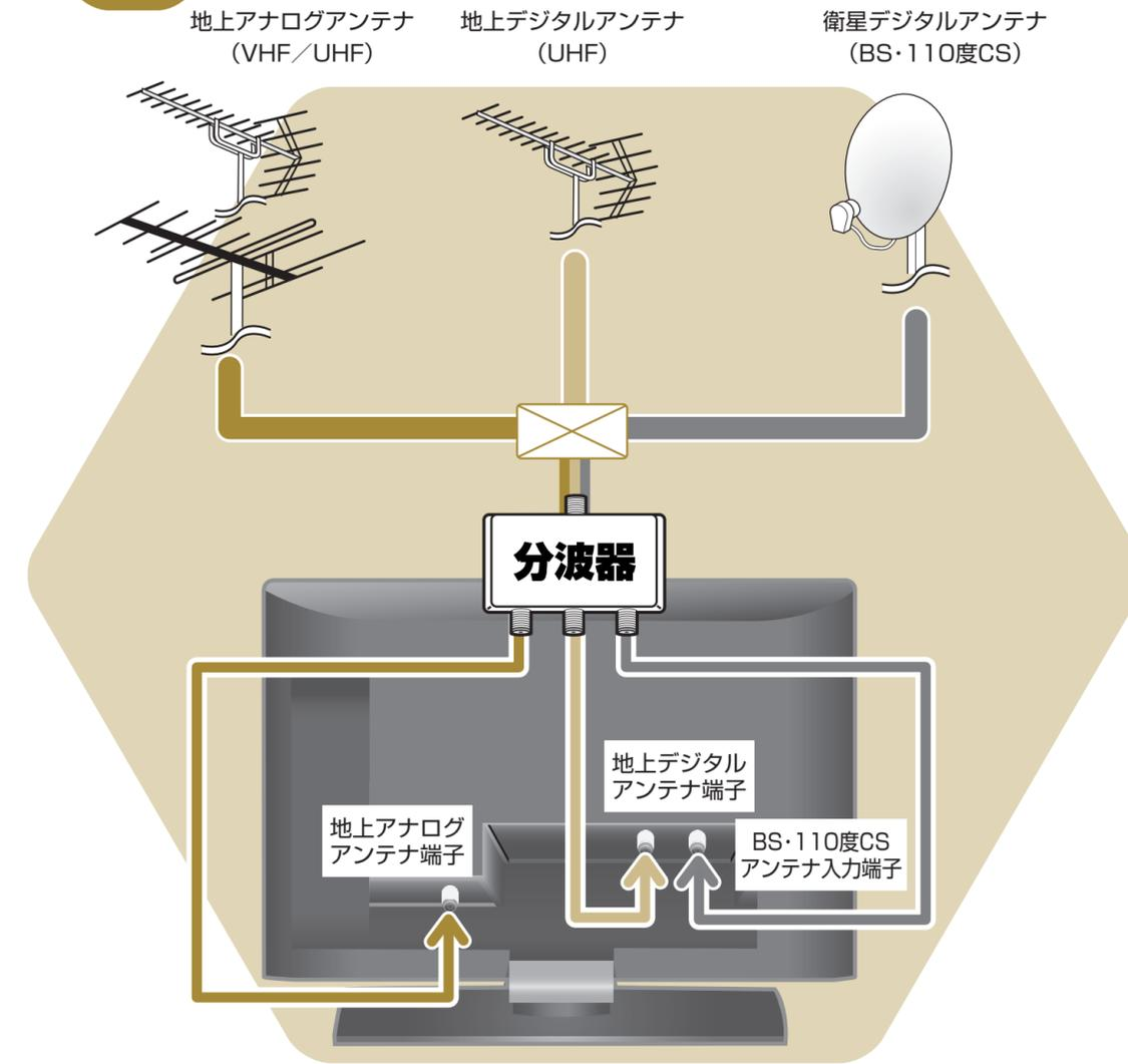
アンテナコード(地上アナログアンテナ用)の先端には、F型接栓(付属)をつなぎます
