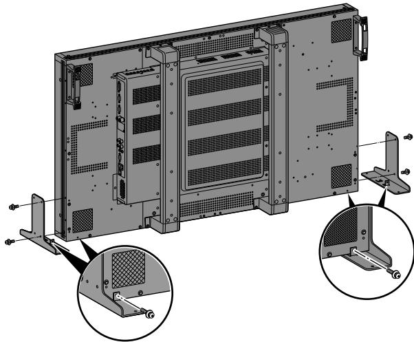
При установке монитора на подставках всегда используйте только прилагаемые в комплекте поставки подставки и подсоединяйте их надлежащим образом. Закрепите подставки с помощью прилагаемых винтов, как это показано на рисунке.
