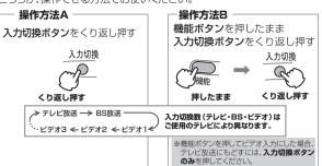
操作方法A、Bどちらの切換え方法でも入力切換えができない場合は、テレビのメーカ一設定をやり値し、「手順2」でメーカーボタンの押す回数を変えてください。 米メーカーによっては、入力切換えのみりモン1倍言が異なる場合があります。
