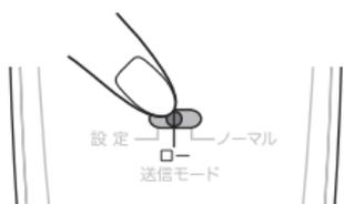
本体裏面の送信モードスイッチを、「ロー」に切換えます。
